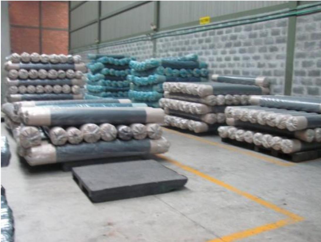
Los rollos de polietileno tienen un peso promedio de 50 a 60 kilos, poseen un ancho de 1,50 metros y un diámetro de 20 centímetros aproximadamente.
