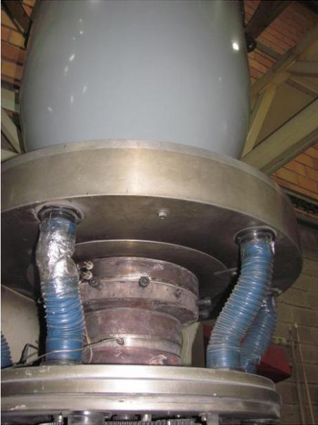
**Pasó cuatro:** mediante la extrusión el polímero es calentado para que se fusione y soplado para darle forma.
