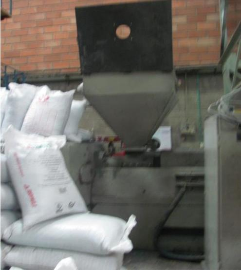
**Paso dos:** el polietileno es introducido en la maquina procesadora.
