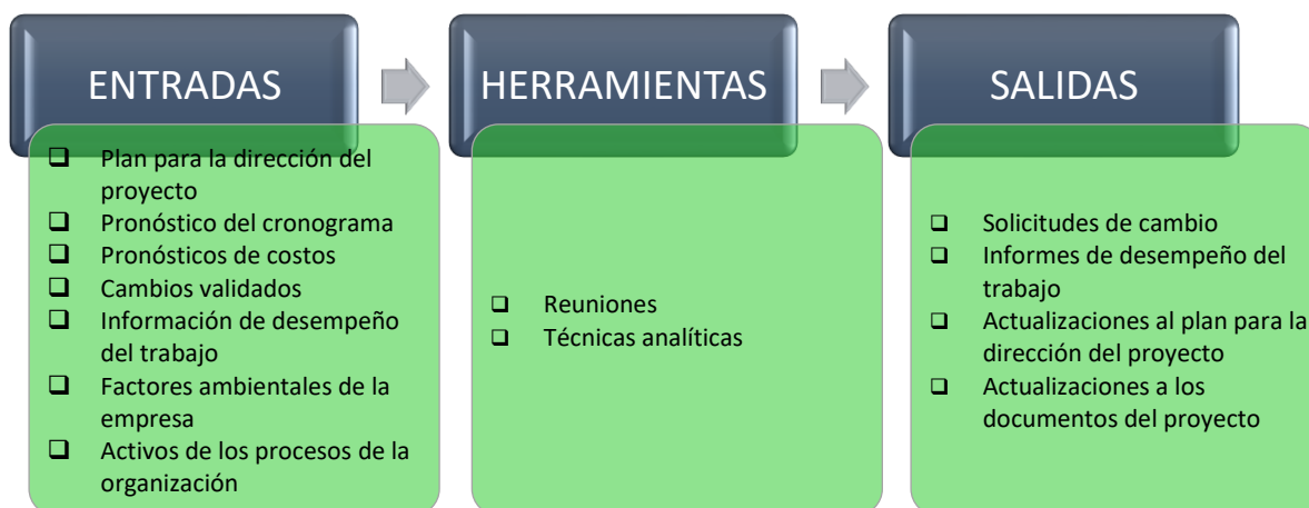
Figura 54. Entradas, herramientas y salidas para Monitorear y Controlar el Trabajo del Proyecto.
