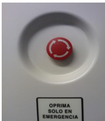
Foto 16. Pulsador-botón de emergencia de pasajeros- bloque de contacto, cuando se presenta problemas con este se dan altos porcentajes de evacuación o retraso de unidades.
