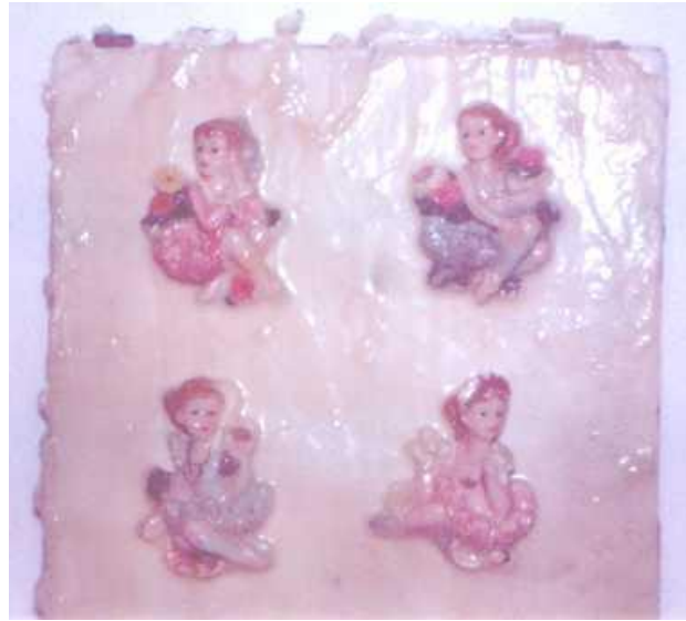
Figura 42. Pegada látex en el molde original
