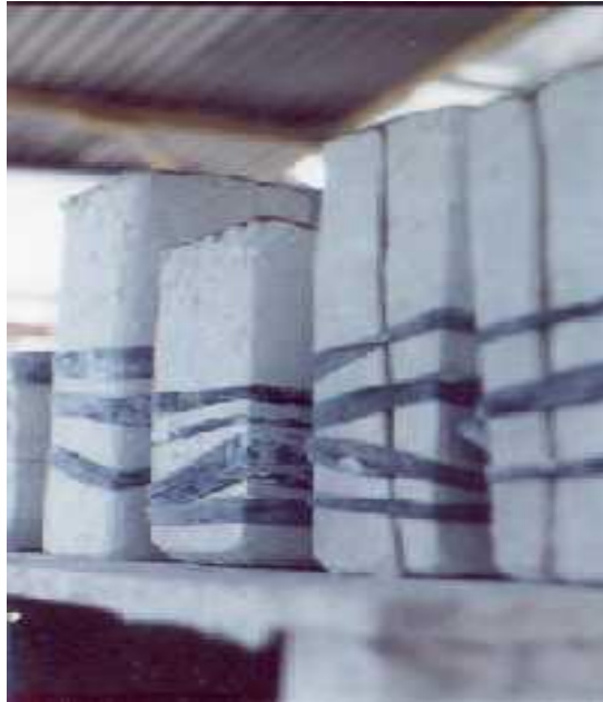
Figura 44. Contramolde en yeso
