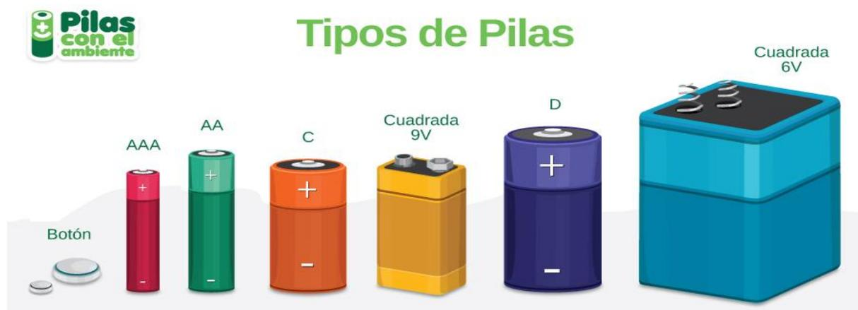
**Figura 4** Tipos de pilas.
