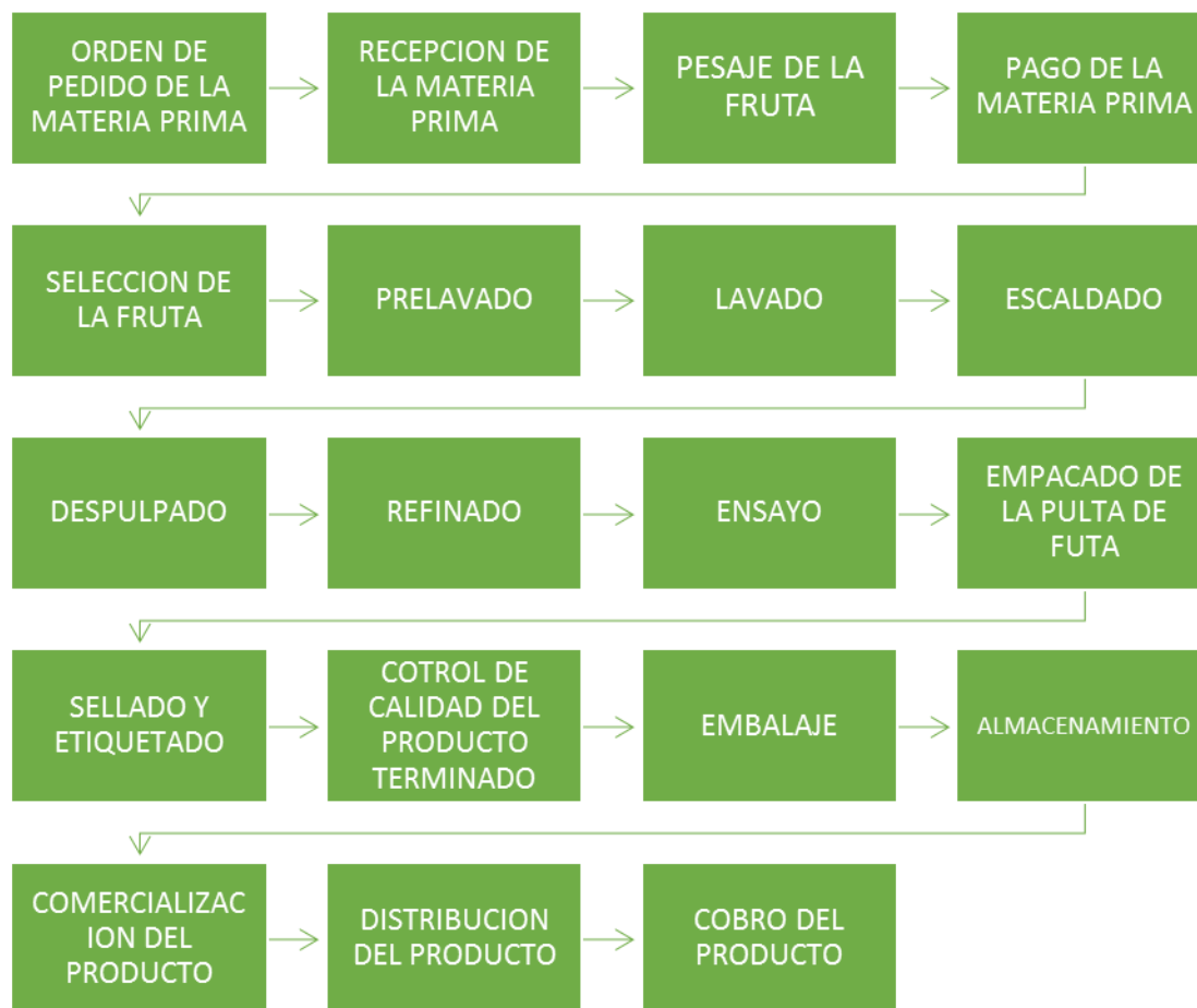
Figura 24. Descripción del proceso de producción
