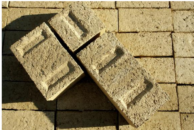
Ilustración 1.1 Ladrillo de hempcrete
