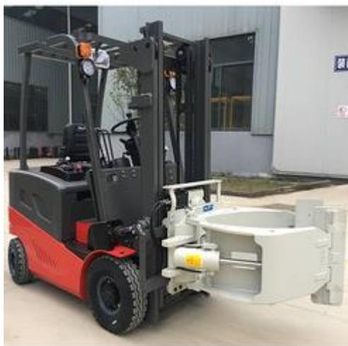
*Ilustración 12. Carretilla elevadora con abrazadera para rollo de papel*
