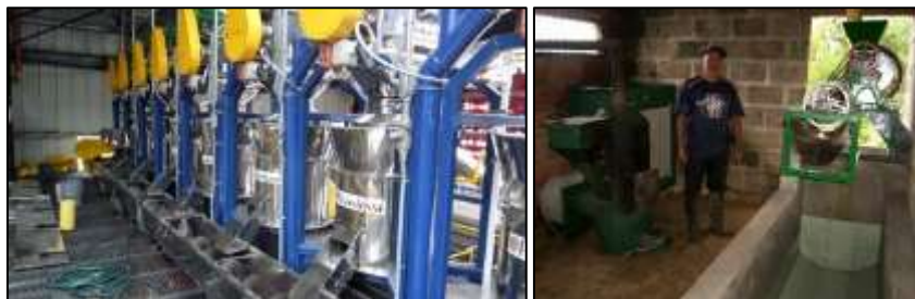
Ilustración 14- Despulpado industrial – Despulpado tradicional – Fuente propia
