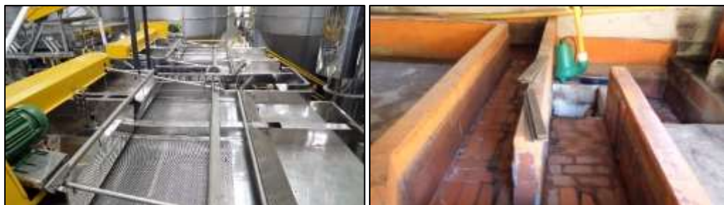
Ilustración 13- Maquina para la clasificación del grano por densidad Industrial – Canal de correteo beneficio tradicional
