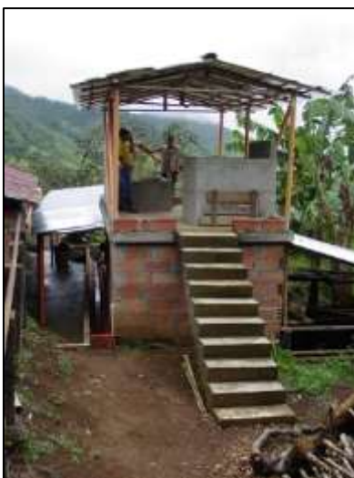
Ilustración 8 - Beneficio tradicional de café (Sistema de tolva para recibo de café en cereza) - Fuente propia
