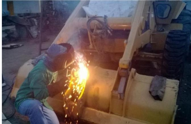
Figura 11. Soldadura proceso SMAW
