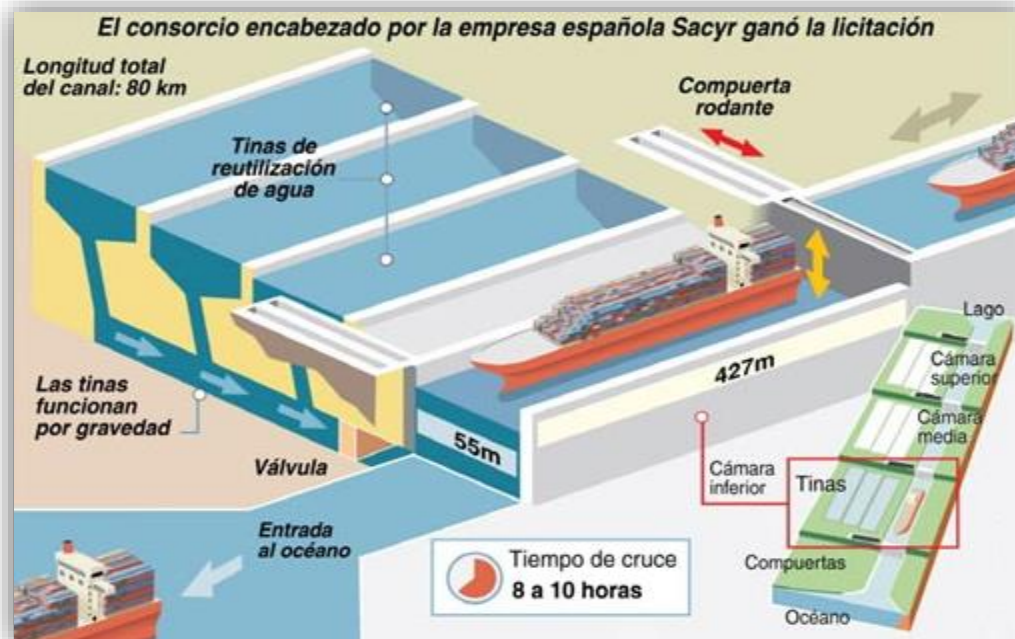
Ilustración 5: Comportamiento y medidas de las Nuevas Esclusas
