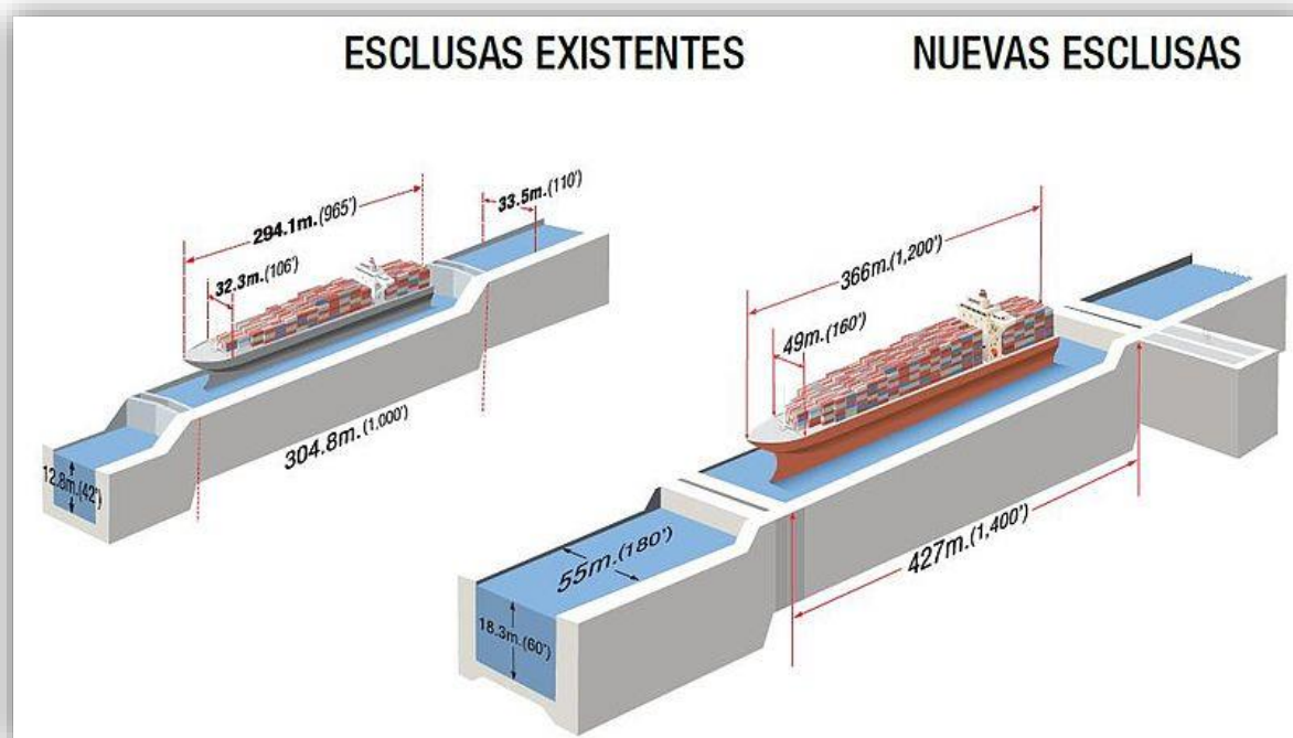
Ilustración 6: Comparación de medidas entre Esclusas Viejas y Nuevas
