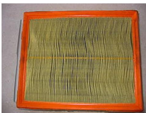
Este es un tipo de filtro de aire usado en los vehículos que funcionan a gasolina, y que necesitan para su funcionamiento. El aire que pasa a través de él, se limpia para proveerle al motor un aire sin impurezas ni partículas de polvo que causan daño a las piezas que lo conforman.
