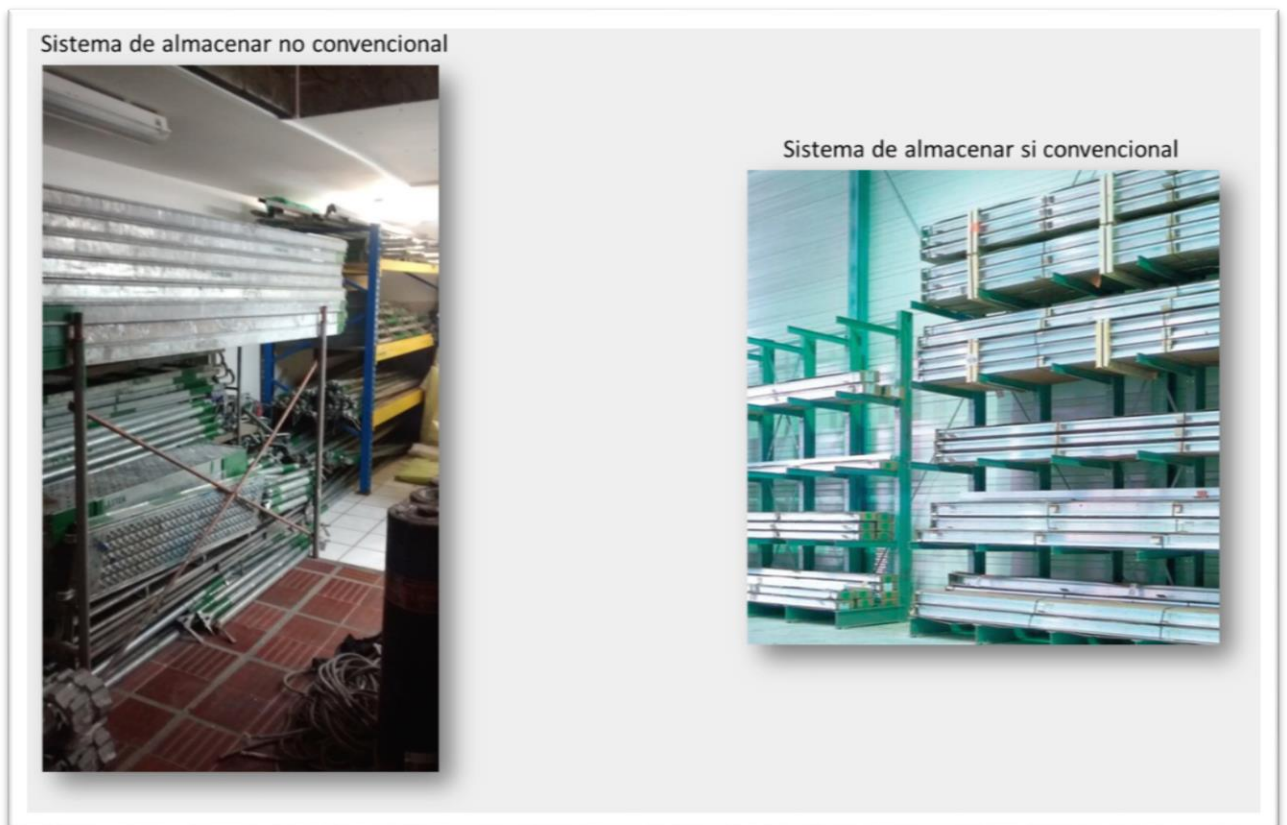
Ilustración 4: sistema de almacenamiento cantiléver
