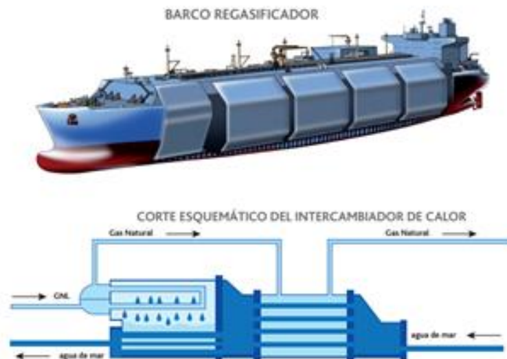
Imagen 2. Estructura de un barco regasificador.
