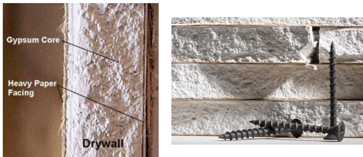
Ilustración 13. Composición placa de yeso o drywall
